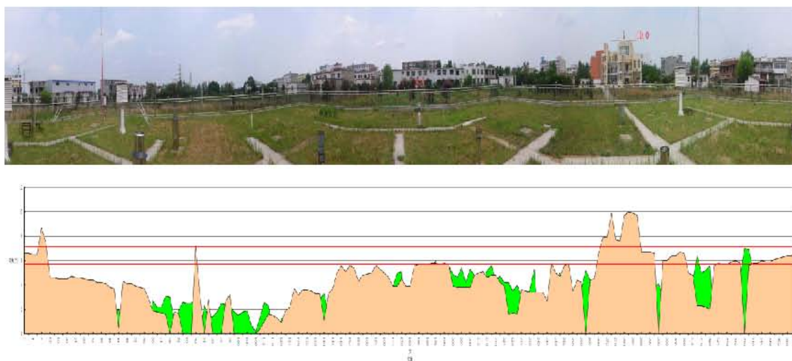
图3.5 潢川气象观测场四周可视范围内遮蔽物仰角图及地面观测场四周全景照片
